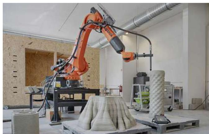
Braço robótico e equipamento de extrusão.
