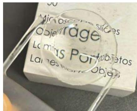
Exemplo de uma lente obtida através de impressão 3D no Projeto AM-OPTICAL.
