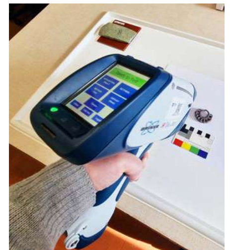
Espectrómetro portátil de XRF para análise elementar in-situ de materiais do Património Cultural.
