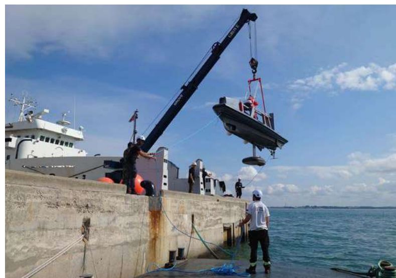
DriX no seu sistema de atracagem (DDS) a ser lançado ao mar.
