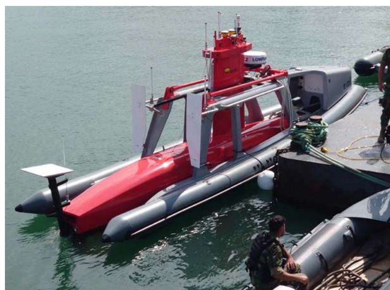
DriX no seu sistema de atracagem (DDS) na doca.
